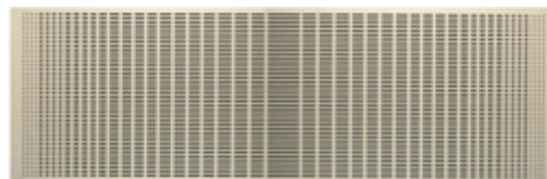
Modelo 2D con ranuras pasantes y de longitud variable e incremental respecto al centro del panel
